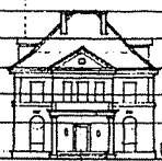
edificio bajo Se entiende por tal el que consta de uno, dos o tres pisos y, por lo general, carece de ascensor.
